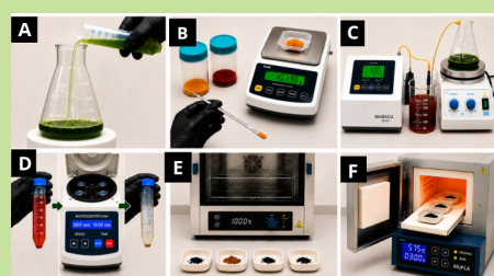
Figura 2: Síntesis verde de NPs de CoFe 2 O 4 por coprecipitación A. Suspensión de microalgas (OD 750 = 0,5). B. Preparación de soluciones de FeCl 3 ·6H 2 O (0,63 M) y CoCl 2 ·6H 2 O (0,3 M). C. Nucleación de NPs. D. Centrifugación y lavados. E. Secado en estufa a 37 y 100 °C. F. Calcinación en mufla a 575 °C 3 horas.
